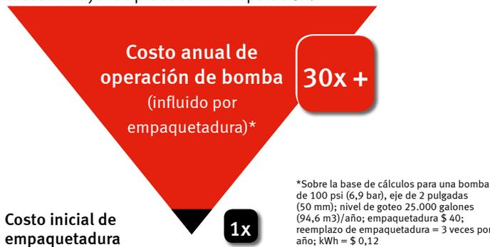
Menos visibles a través del proceso son los efectos del factor de fricción de material que tiene un impacto directo en la potencia y por lo tanto en el costo de operación de la bomba.
